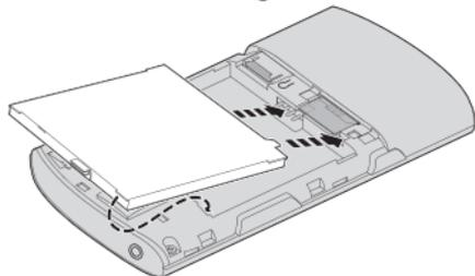
Вставьте язычки в нижней части крышки отсека аккумулятора в пазы на корпусе смартфона. Осторожно нажимайте верхнюю часть крышки, пока защелки по краям крышки не встанут со щелчком на место.
