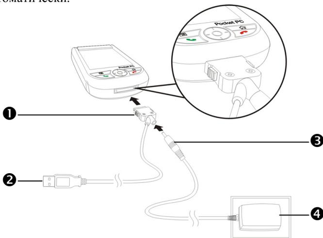
Вы можете заряжать батареи КПК через данный кабель без подключения блока питания. Но рекомендуется заряжать батареи обычным методом – с использованием блока питания.
